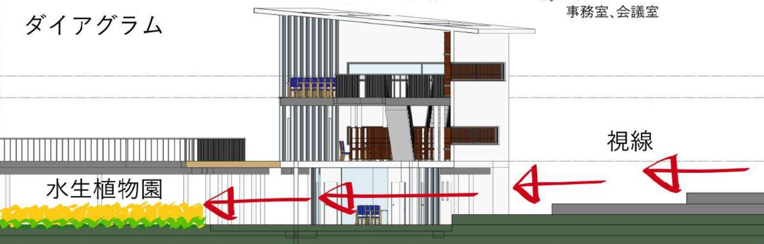
2階部分を持ち上げて柱で支え、1階部分をガラス張りにすることで透明性を確保し、水生植物園への視線が通りやすいようにした。
